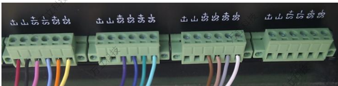
图 5-7 仪表传感器接线图
