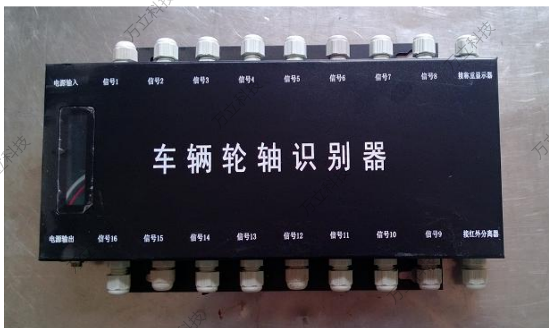
图 4-4 轮轴检测单元车辆轮轴识别器
